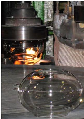
➤ unsere Glaskörper maschinell eingeblasen werden. Im Gegensatz zu mundgeblasenen Artikeln erreichen wir damit eine sehr gleichmäßige Wandstärke und können eine Temperaturwechselbeständigkeit von mindestens 150°C garantieren.
